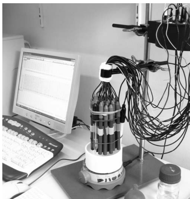
Рис. 2. Действующий лабораторный прототип электронного языка на основе потенциометрических сенсоров
