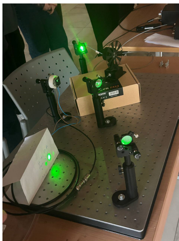
Рис. VI.2.3. Пример собранной и настроенной схемы интерферометр
