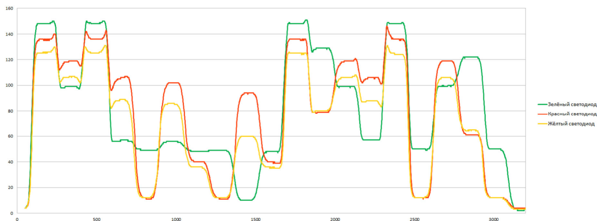
Рисунок 10. График сигнала, снятого с шестерни ст35 (код ст), начиная со стартового условия, тремя энкодерами с разным цветом светодиодов: красным, желтым и зеленым.
